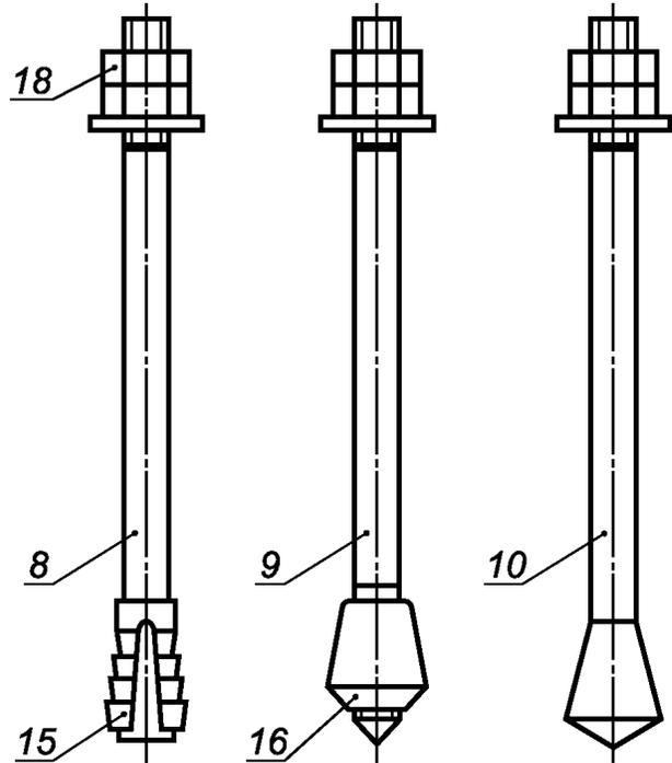
1—10 — шпильки; 11, 12 — анкерная плита; 13 — муфта; 14 — анкерная арматура; 15 — разжимная цапга; 16 — коническая втулка; 17 — шайба; 18 — гайка по ГОСТ 5915; 19 — гайка по ГОСТ 10605
